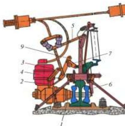
1 — головка ключа; 2 — винтовой зажим; 3 — планка; 4 — мотор-редуктор; 5 — поперечина;
