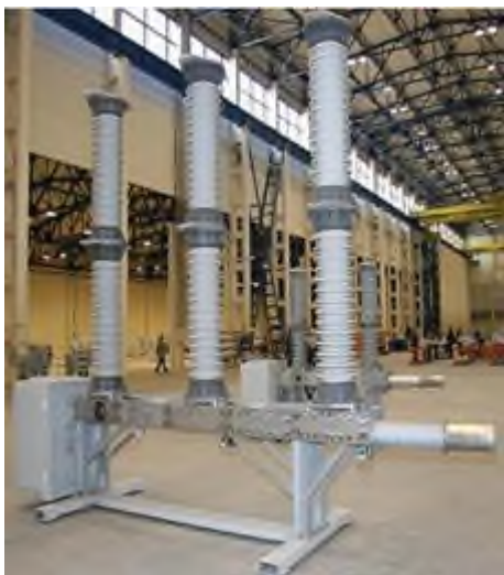
Рисунок 4. Элегазовый выключатель ВГТ-110,
