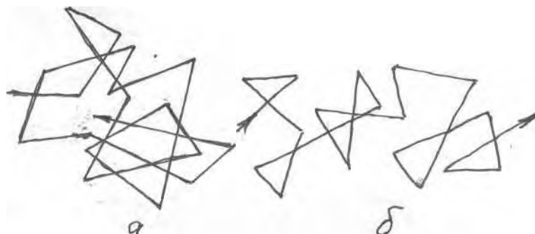
Рис.1. Траектория движения электрона: а) без поля; б) в электрическом поле напряженностью E .
