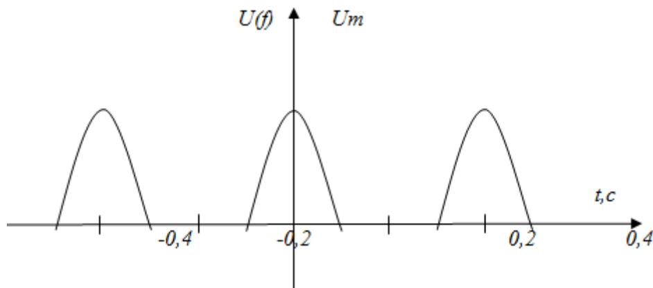
*Решение.* Нетрудно определить, что период повторения импульсов  $T=0.4$ с. Частота первой гармоники  $\omega_1 = \frac{2\pi}{T} = \frac{2\pi}{0.4} = 5\pi$  рад/с. В пределах периода напряжение  $u(t)$  определяется выражениями
