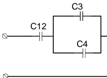
Из схемы №2 следует, что конденсаторы  $C_3$  и  $C_4$  соединены параллельно, значит
