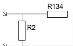
Из схемы №3 следует, что сопротивления  $R_2$  и  $R_{134}$  соединены параллельно, значит
