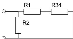
Из схемы №2 следует, что сопротивления  $R_1$  и  $R_{34}$  соединены последовательно, значит
