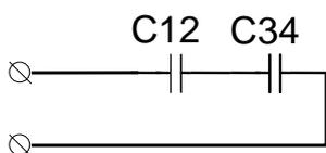
Из схемы №3 следует, что конденсаторы  $C_{12}$  и  $C_{34}$  соединены последовательно, значит
