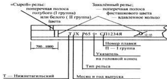
Маркировка новых рельсов: в торце (а) и вдоль (б) рельса
