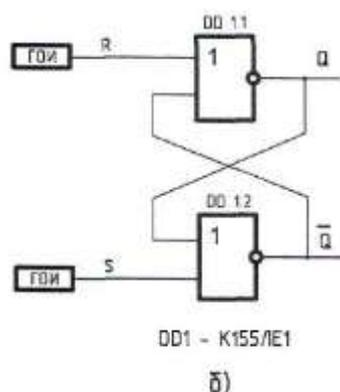
Осуществите управление режимами работы триггеров. Фиксируйте моменты изменения состояния триггеров с помощью светодиодных индикаторов.
