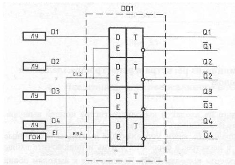
Рис.2. Схема подключения микросхемы TM7
