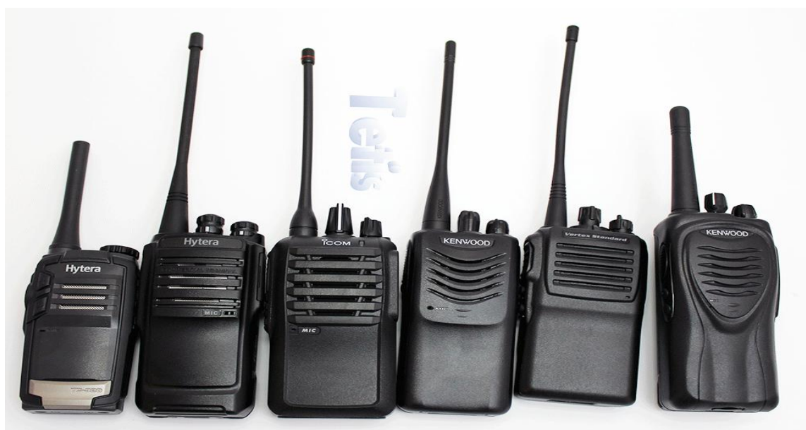
Рис. 2 Носимые радиостанции, применяемые на железнодорожном транспорте
