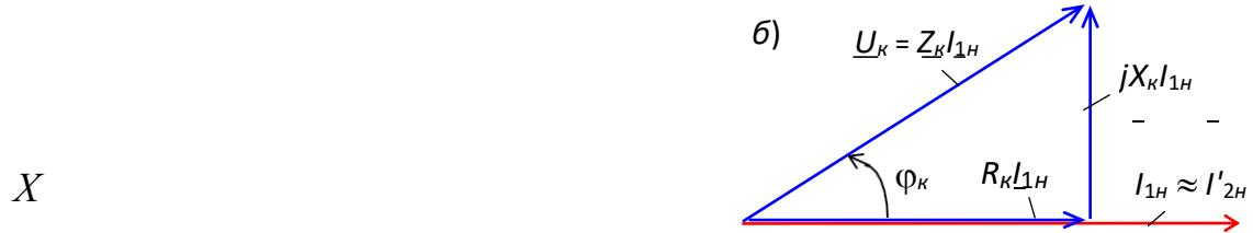
Рис.6. Схема первичной обмотки трансформатора и векторная диаграмма напряжений на ней в режиме КЗ.
