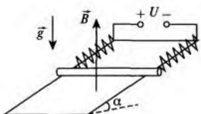
К клеммам стоек подводят постоянное напряжение  $U = 4$  В. Определите максимальное удлинение пружины, если в пространстве создать однородное магнитное поле с индукцией  $B = 0,1$  Тл, направленное вертикально вверх. (Коэффициент трения проводника о плоскость клина  $\mu = 0,1$ , его сопротивление  $R = 20$  Ом. Сопротивление пружин не учитывать) (оценивается 3 б.)
