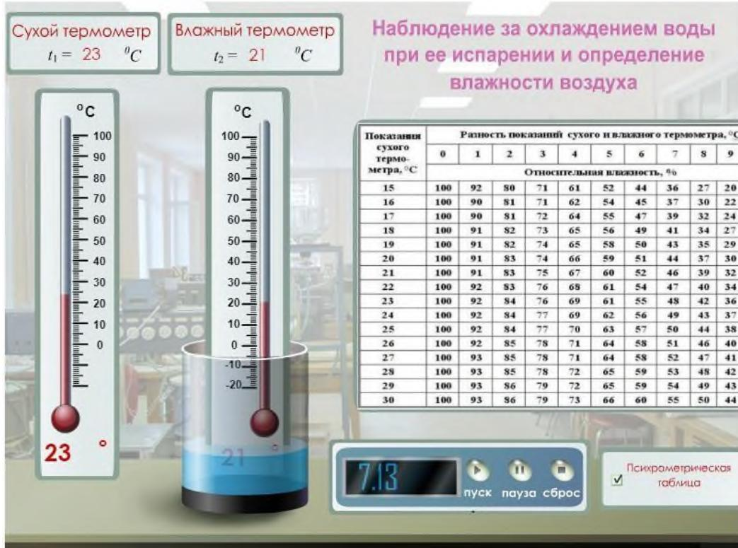
Рисунок 3 – Стенд виртуальной лабораторной работы
