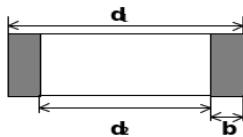
При поднятии кольца с поверхности происходит разрыв поверхности жидкости по кромкам кольца. Длина границы перед отрывом кольца, по которой происходит разрыв поверхности, составляет
