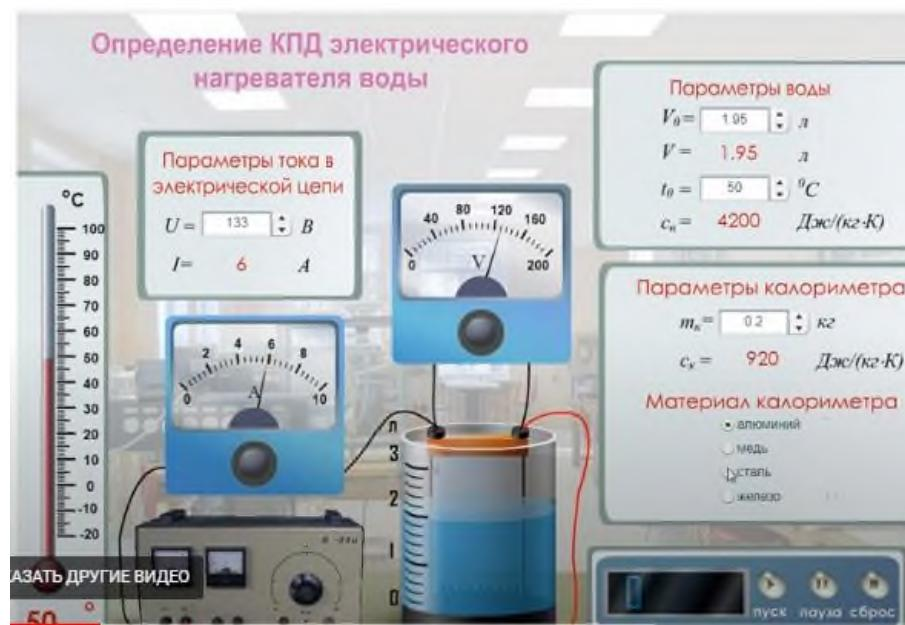
Экспериментальная установка представлена на рисунке. В правом нижнем углу представлена панель «параметры калориметра» выбор массу калориметра и массу воды, которая будет в нем. Панель: «материал калориметра» - для выбора материала: медь, алюминий, сталь, железо. Выше есть панель «параметры воды», где можно выбрать начальную температуры воды и ее объем.
