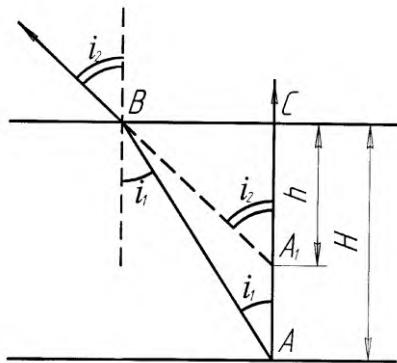
Существует связь между действительной толщиной  $H$  исследуемой пластиинки, кажущейся толщиной и показателем преломления стекла. Установить эту связь можно из рассмотрения хода лучей от точки  $A$  через стеклянную пластиинку. При этом предлагается, что глаз находится на той нормали к плоскости пластиинки, которая проходит через точку  $A$ , и пучок лучей  $AB$  составляет с нормалью малый угол  $\alpha$ .
