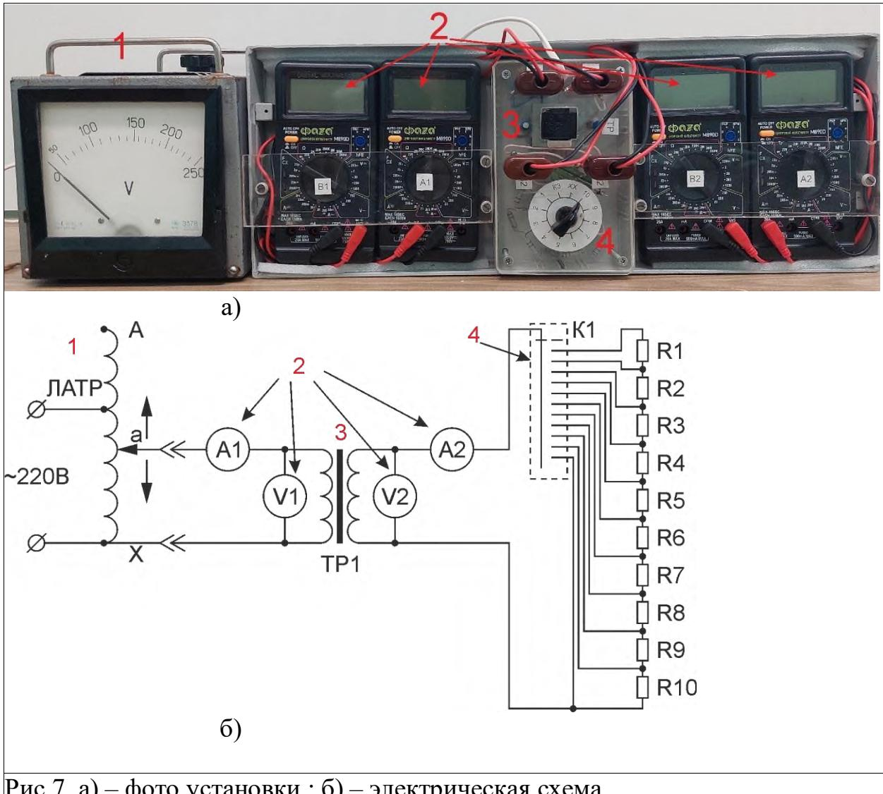
Рис.7. а) – фото установки ; б) – электрическая схема.
