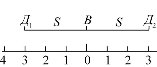
Так как угол  $\varphi$  мал, то  $\operatorname{tg}\varphi$  можно с достаточной степенью точности заменить  $\sin\varphi$ , т.е.  $\sin\varphi = \frac{S}{R}$ .
