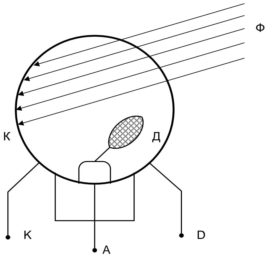
Рис. 1.6. Схема фотоэлемента с усилением фототока:
