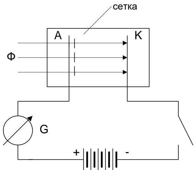
Рис. 1.1. Устройство и схема включения фотоэлемента: А- анод; К- катод; Г- гальванометр;  $\Phi$ - световой поток
