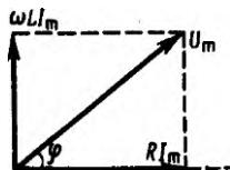
Рис.4. Векторная диаграмма напряжений на последовательно включенных сопротивлениях  $R$  и индуктивности  $L$ .
