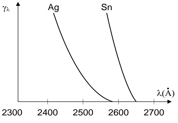
Рис.1.4. Спектральная чувствительность  $\gamma_\lambda$  фотокатода
