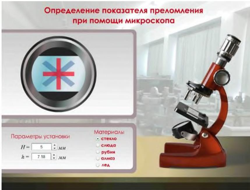
Экспериментальная установка представлена на рисунке. В левом нижнем углу представлена панель «параметров пластины», в которой можно менять значение  $H$  и  $h$ . Правее находится панель выбора материала пластиинки, нам понадобится материал только стекло. В крайнем левом углу
