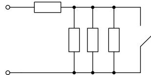
11. Определить количество теплоты, которое выделяется в резисторе сопротивлением  $R = 20 \text{ Ом}$  за время  $t = 2 \text{ часа}$ , если  $U = 220 \text{ В}$ .
